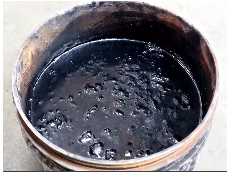
Juuri pestystä BMW-auton DPF-suodattimesta irtosi ämpärillinen ryönää. Lieite on myrkyllistä ongelmajätettä, joka pitää käsitellä asianmukaisesti.
